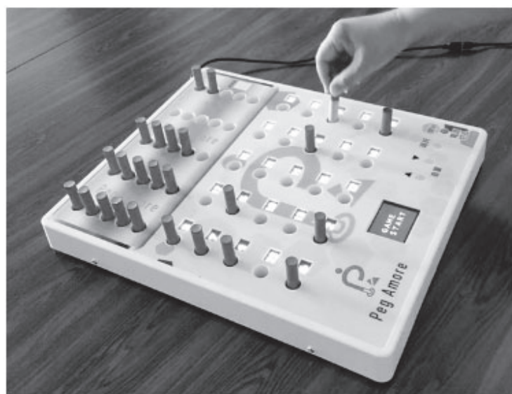
図2 本研究で用いた手指巧緻性トレーニング電子化機器（ペグ・アモーレ）
