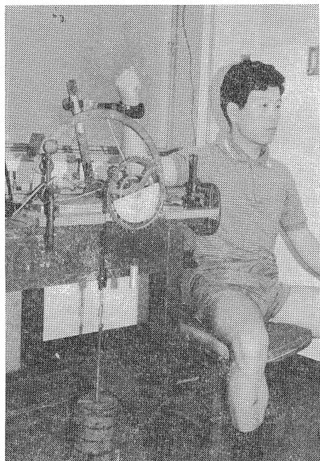
図1 パワーのトレーニングとテストのための荷重負荷装置
