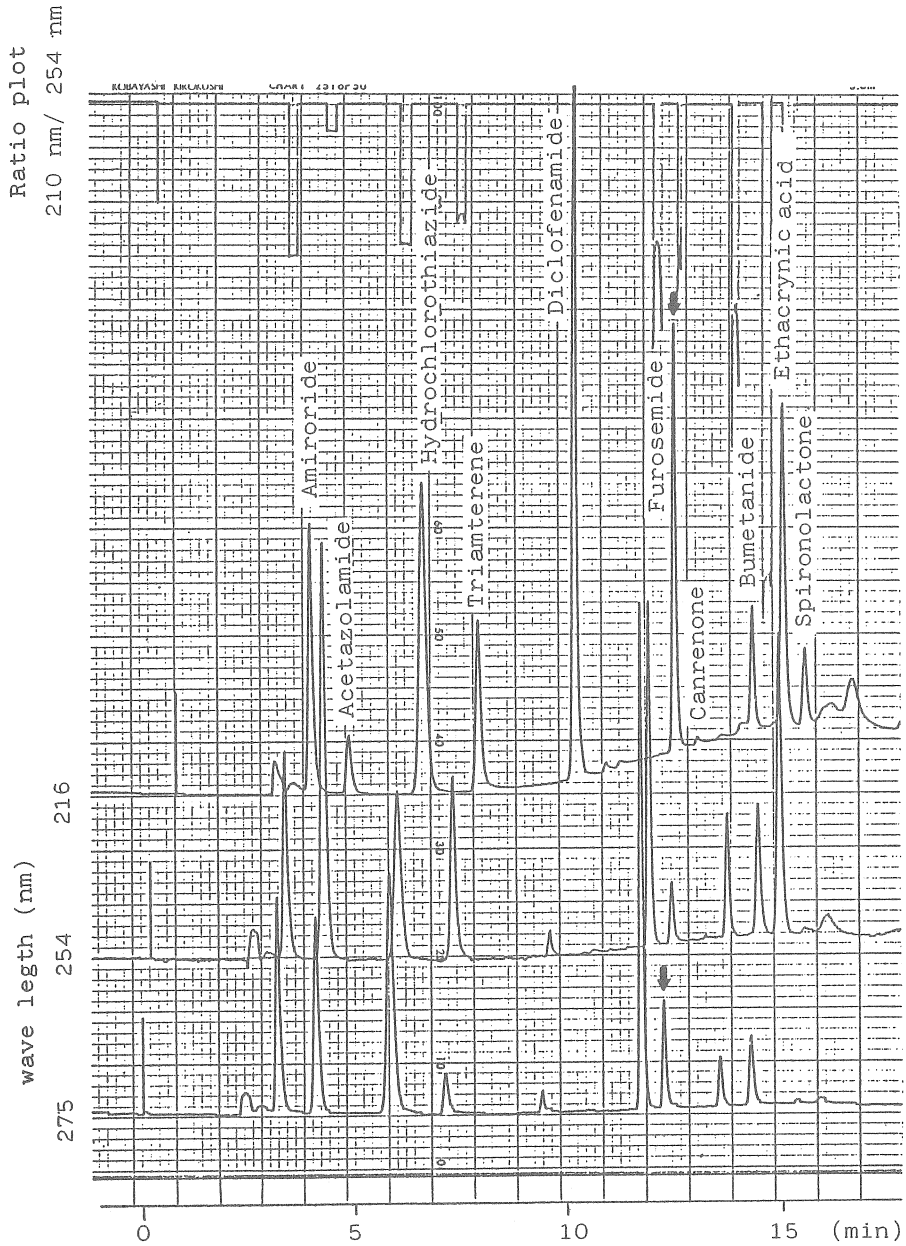
図 - X I 新しHPLC条件を用いた利尿剤の分析結果 (HPLCクロマトグラム)
