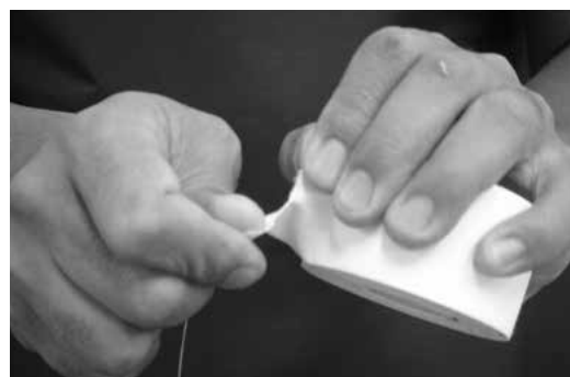
図 VI-B-242 テープの切り方2 テープロールを持っている手を手前に引く。
